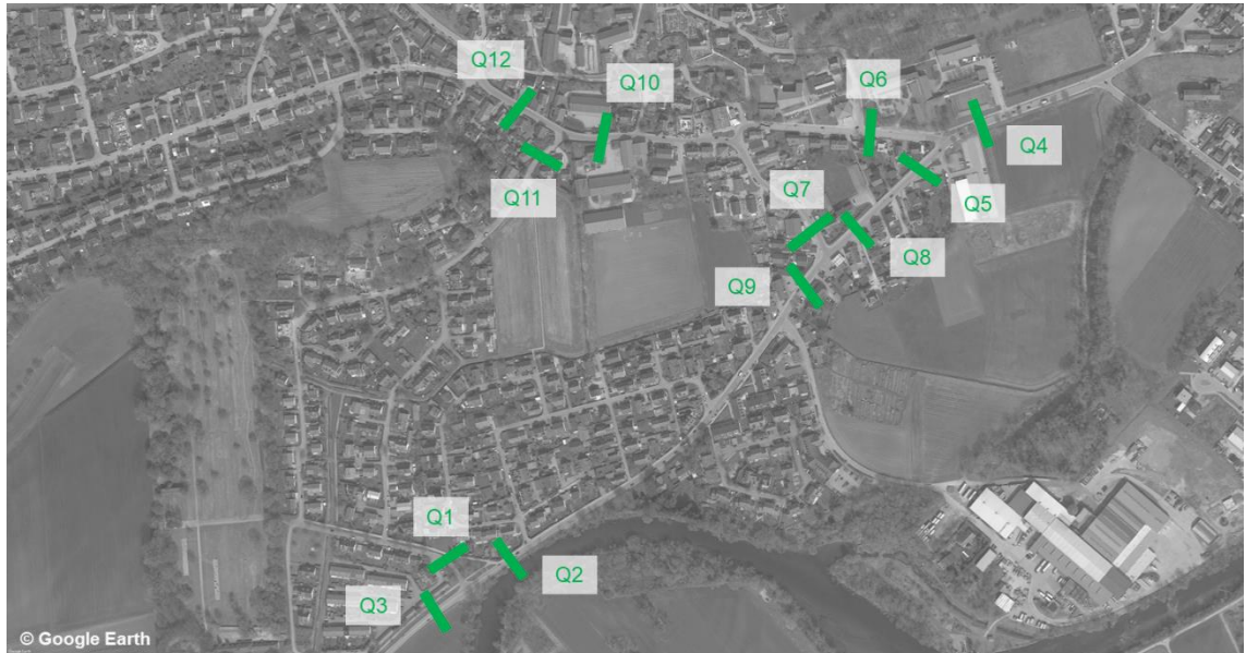
Abbildung 23: Maßgebende Querschnitte für die schalltechnische Untersuchung [Hintergrund: Google Earth Pro]
